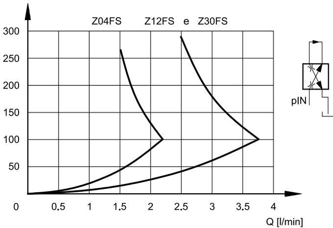
Portata P→B / A→T con valvola in posizione di emergenza (fail safe) in funzione della pressione in ingresso.
